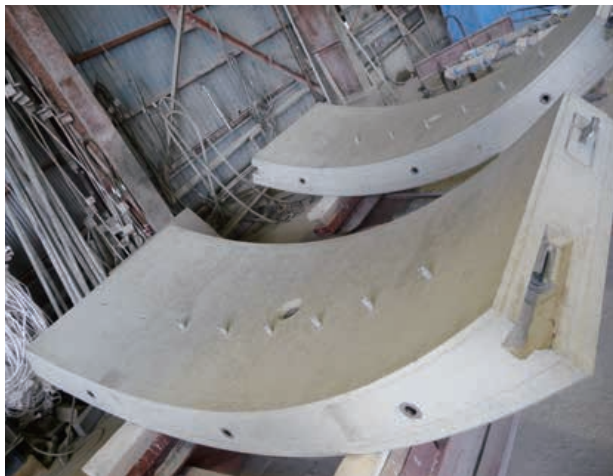
シールドトンネル内の 電力ケーブルラック インサート
